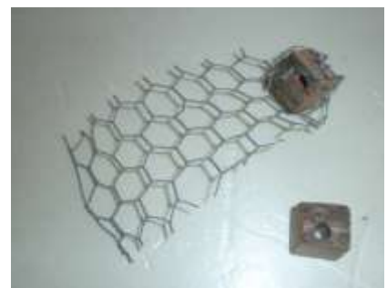
3 Befestigungshölzer mit Kaninchendraht
